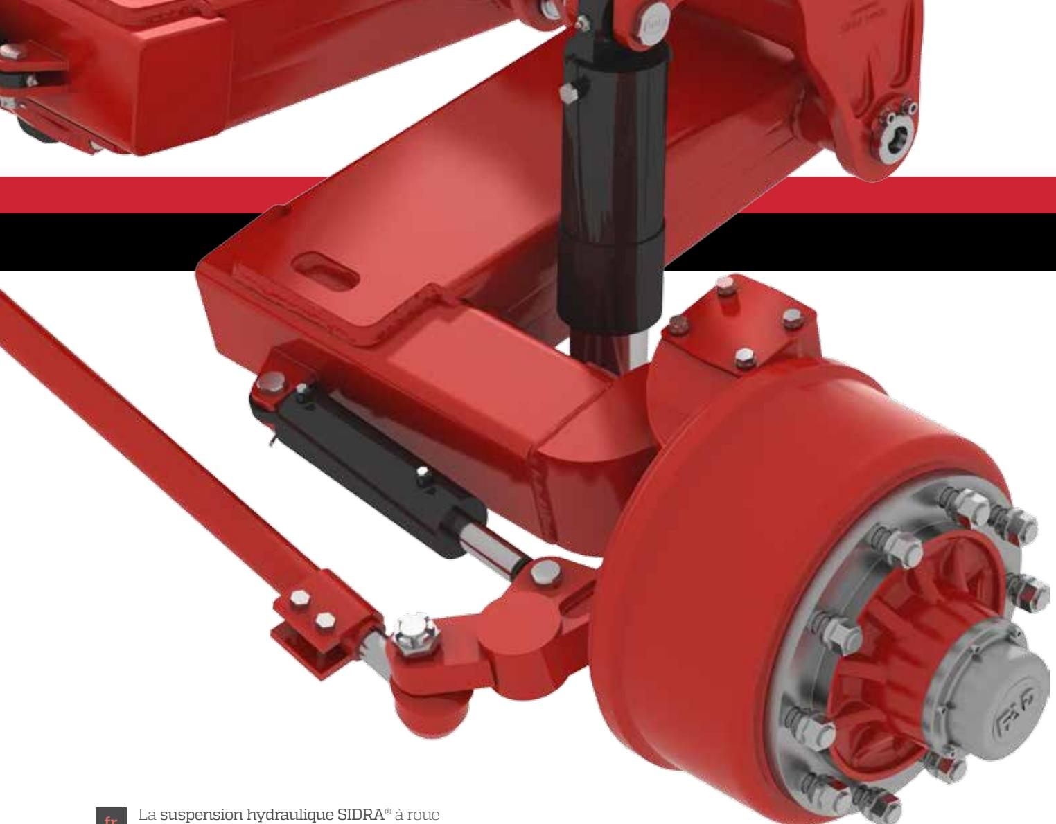
**fr** La suspension hydraulique SIDRA® à roue indépendante est un module autoportants avec demi-essieux auto-directionals ou fixes tous freineint et équipé avec un système hydraulique qui agit comme une suspension.
